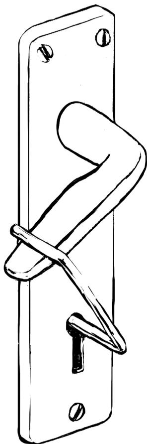
Con un fil di ferro piegato in maniera speciale, potete far scattare dall'esterno il pressore. Nelle serrature a doppia barba la cosa è molto più semplice perché il buco della serratura è più largo. Con un po' di bravura questo metodo si può utilizzare con successo anche con le serrature a doppia barba e in quelle a Chubb.
