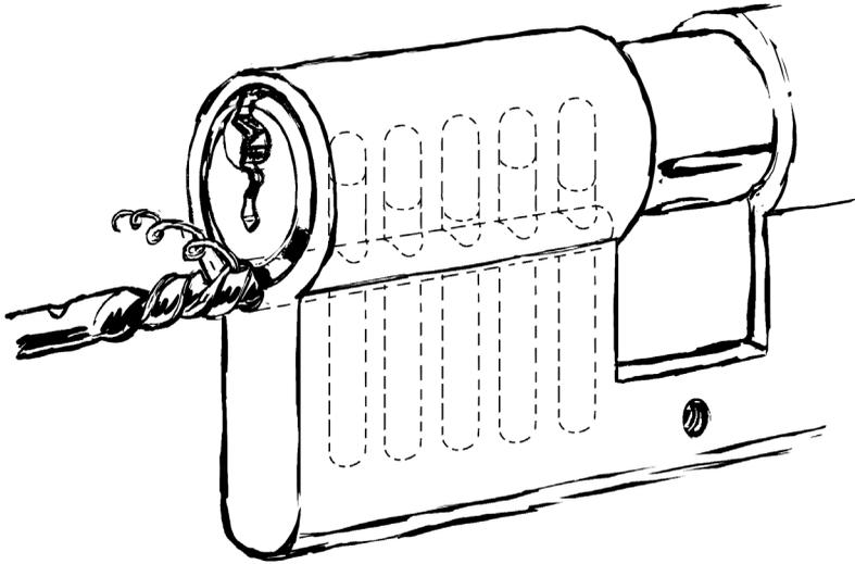
Ripetete questo procedimento fino all'ultimo perno (al massimo cinque). In realtà dovrete trapanare anche l'ultimo perno. Per essere sicuri di averlo raggiunti, trapanate ancora uno o due millimetri. Fate però estremamente attenzione a non andare troppo a fondo.
